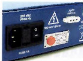
Le tag réalisé par MAINtag (partie ronde et rouge) a été conçu pour être embarqué sur du matériel de vol.
