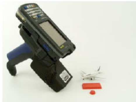
Les 2 modèles d'étiquettes RFID qui équiperont l'A350 XWB mesurent 4,8 x 49 x 24 mm ou 4,8 mm et 14 mm de diamètre et coûtent 15 $ pièce.
